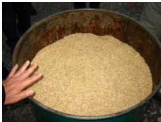
ใส่แกลบวัสดุเหลือจากการทำนาซึ่งปีหนึ่ง ๆ ในไทยมีมากกว่า 4 ล้านตัน โดยบรรจุถังละ 130 กิโลกรัม
